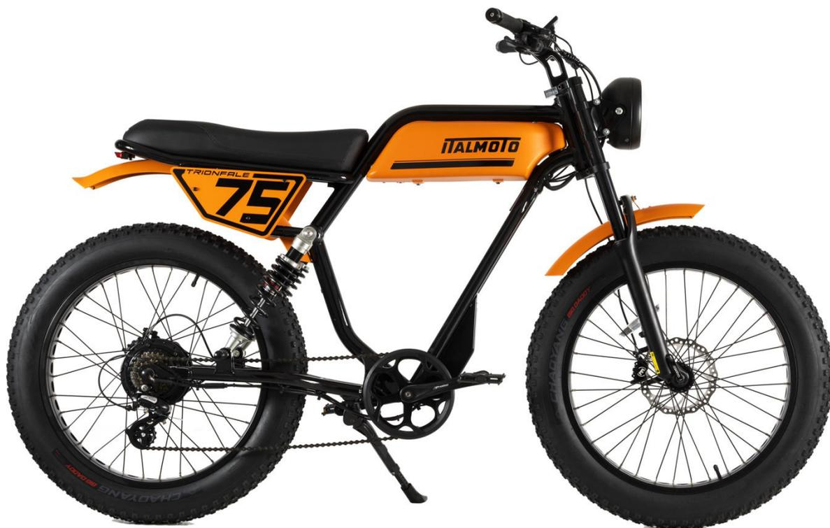
La **ricarica completa** avviene in circa **4/6 ore**. La **batteria** garantisce una **percorrenza massima** di **80 km**, che variano in funzione di fattori quali, ad esempio, la portata (il peso del conducente o del conducente + passeggero), la tipologia di percorso (le salite richiedono uno sforzo maggiore) e le condizioni climatiche.
